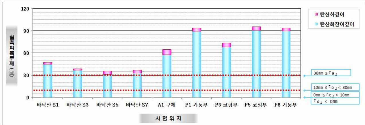
【그림 3.4.17】 탄산화 깊이 측정결과(부산)
